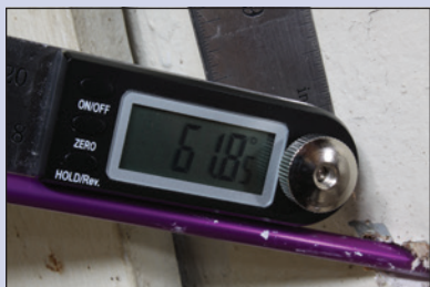
Tome a medida do ângulo de entrada com o transferidor digital Nº DRP10
