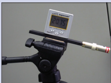
Tome a medida do ângulo da trajetória com o localizador digital de ângulos DMANGLE e o laser montado no tripé usando o adaptador de tripé
