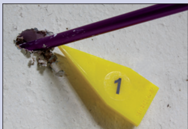
Vareta de penetração, marcador SirchMark™ fixado com Stikki Dot identificando o local e o ângulo de entrada
