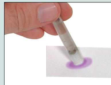
Aplicando reagente em transferência por contato não destrutiva.
