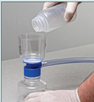
Depois de varrer a área de interesse quanto ao DNA, despeje a solução-tampão coletada por meio do filtro, vede o filtro em um saco poroso fornecido com fita de integridade e envie ao laboratório para análise.
