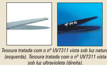
Tesoura tratada com o nº UV7311 vista sob luz natural (esquerda). Tesoura tratada com o nº UV7311 vista sob luz ultravioleta (direita).
