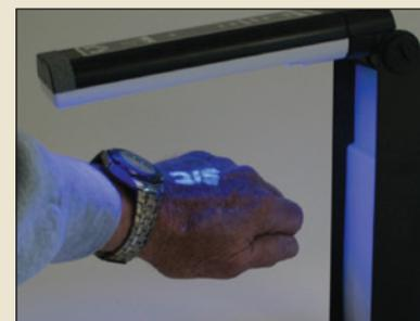
A tinta marcadora invisível para pele não é visível em luz natural, mas é altamente fluorescente quando exposta à luz UV (mostrada em uso com o nº UVP900).
