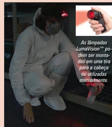
As lâmpadas LumaVision™ podem ser montadas em uma tira para a cabeça ou utilizadas manualmente.
