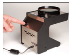
Para usar, deslize o filtro de isolamento (incluído) na parte dianteira da unidade e ligue a alimentação (110 V CA ou 220 V CA).
