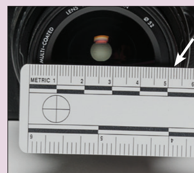
Medida do tamanho da rosca do filtro: As rosca de filtro são medidas em milímetros, portanto use uma régua. Coloque a régua ao longo do diâmetro (parte mais larga) da lente da câmera conforme a ilustração, começando na borda interna das rosca do filtro e meça até o lado oposto.
