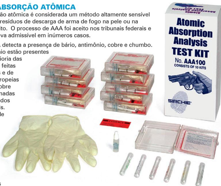
Devido à extrema sensibilidade da análise de absorção atômica, os cotonetes, os tubos de preservação, a solução de ácido nítrico e o recipiente devem estar livres de contaminação.
