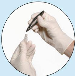
1. É adicionado um grão do material suspeito a um frasco de retenção de extrato.
