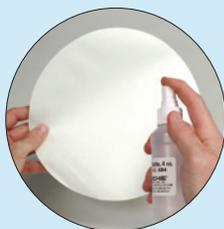
1. Pulverize uma solução reagente preparada sobre toda a superfície do papel de contato para detecção de pólvora e coloque diretamente sobre a área da roupa a ser examinada.
