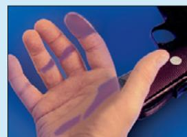
O metal vestigial é detectado após a aplicação do reagente e a exposição à luz UV de ondas curtas.
